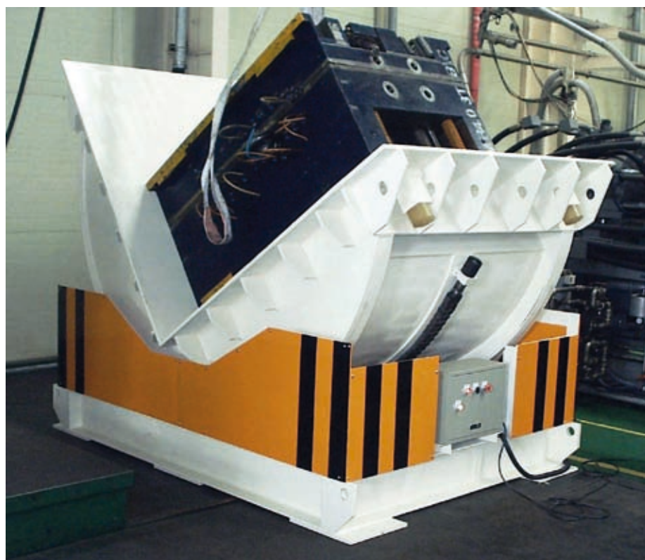
Mit EAS-Kippvorrichtungen wird das Sicherheitsniveau bei der Manipulation vor allem schwerer Werkzeuge erhöht.
