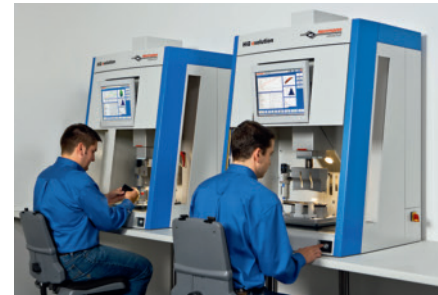
Bild 6. Bei der Ultraschallschweißmaschine HiQ evolution sind Zustellhöhe und Fahrgeschwindigkeiten frei programmierbar (Foto: Herrmann)
