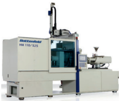
Bild 4. Auf einer HM 110/525 wird das Spritzgießen mit Gasinjektionstechnik demonstriert (Foto: Wittmann Battenfeld)
