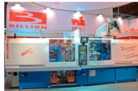
Bild 1. Die Fertigungszelle Select 150T produziert im 2K-Verfahren Teile mit angespritzten Dichtungen (Foto: Billion)
